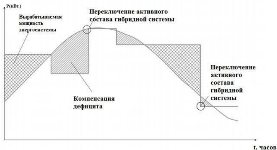
Рисунок 4 – Схема, демонстрирующая обеспечение нагрузки потребителей в периоды неблагоприятных погодных условий
