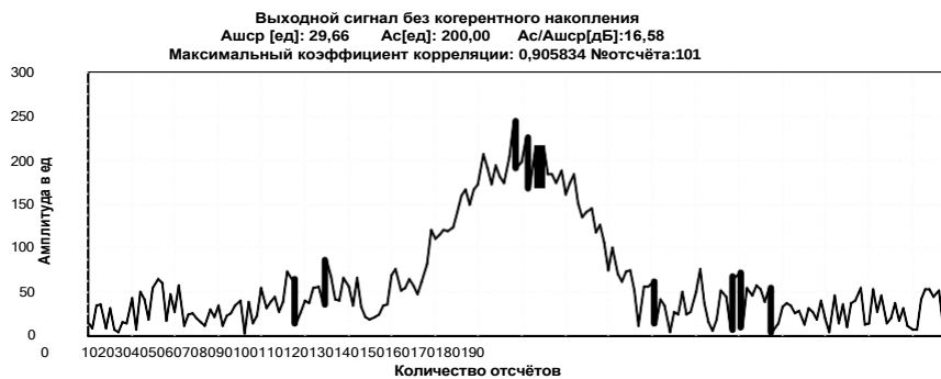
Рисунок 1 – Вид сигнала при коэффициенте корреляции 0,9
