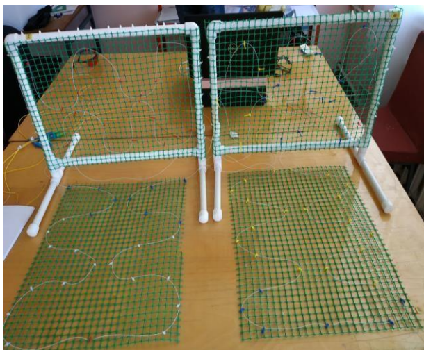
Рисунок 3 – Опытный образец четырёх канальной волоконно-оптической системы охраны
