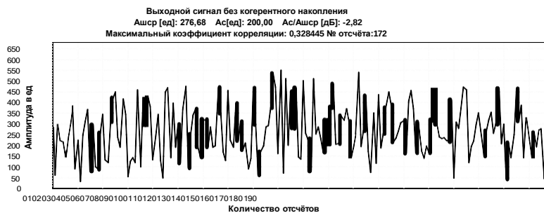
Рисунок 3 – Вид сигнала при отношении сигнал/шум - 2,82 дБ
