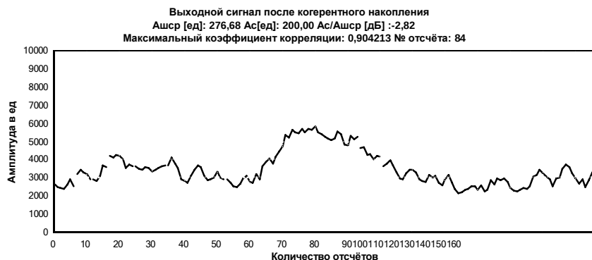
Рисунок 4 – Вид сигнала после применения когерентного накопления
